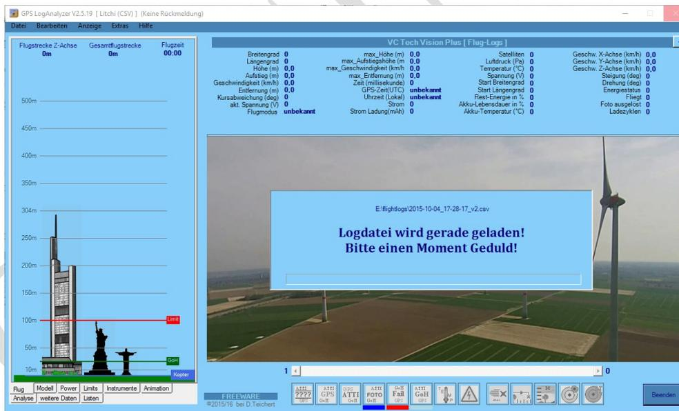
Wurde die Log-Datei erfolgreich geladen so werden die eingeladenen Daten angezeigt. Die Anzeige der Daten erfolgt hierbei in der Form, das immer nur eine Datenzeile der Log-Datei angezeigt wird. Somit ist es möglich sich innerhalb der Log-Datei vor und zurück zu bewegen so das er Zusammenhang der Daten innerhalb der Log-Datei erhalten bleibt. Dies ist wichtig bei der späteren Analyse um eventuelle Probleme oder Ereignisse zu erkennen und beurteilen zu können.
